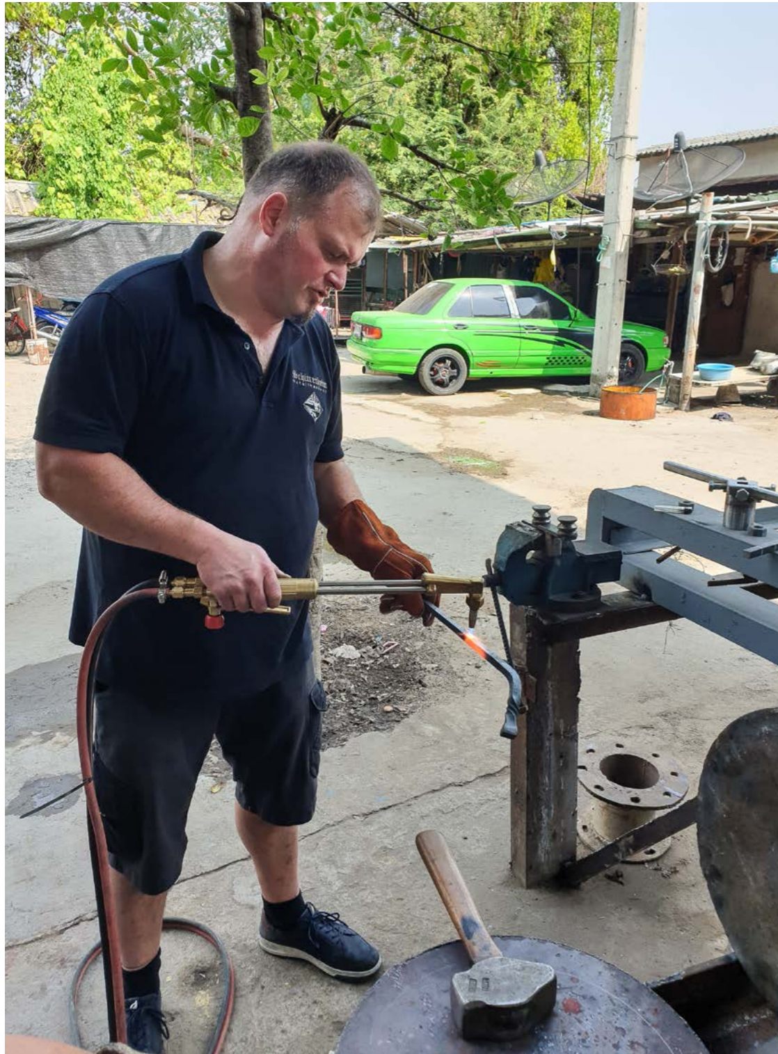
Ein Herz entsteht, der Schneidbrenner ersetzt das Schmiedefeuer
